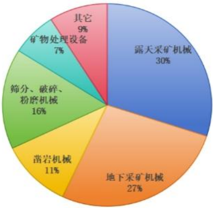
图 4：选矿机械占矿山机械价值量的 32%，核心为破碎、粉磨、筛分、分选装备
