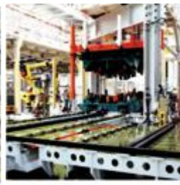
柔性门盖焊接系统
