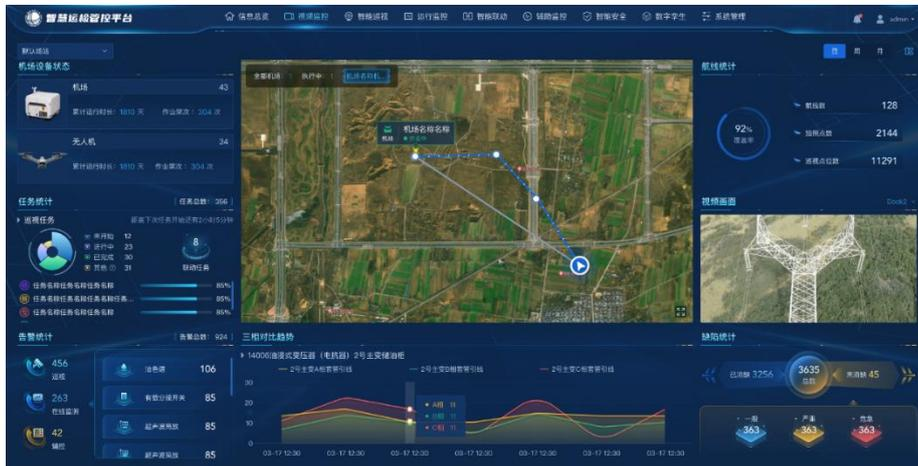
**无人机智能巡检系统：**无人机自主巡检平台支持输、变、配巡检一体化管理，包括杆塔台账管理、巡检计划与任务管理、飞行监控、航线管理、任务调度、缺陷分析、缺陷对接上报等功能，实现无人机电力巡检业务流程闭环管理。
