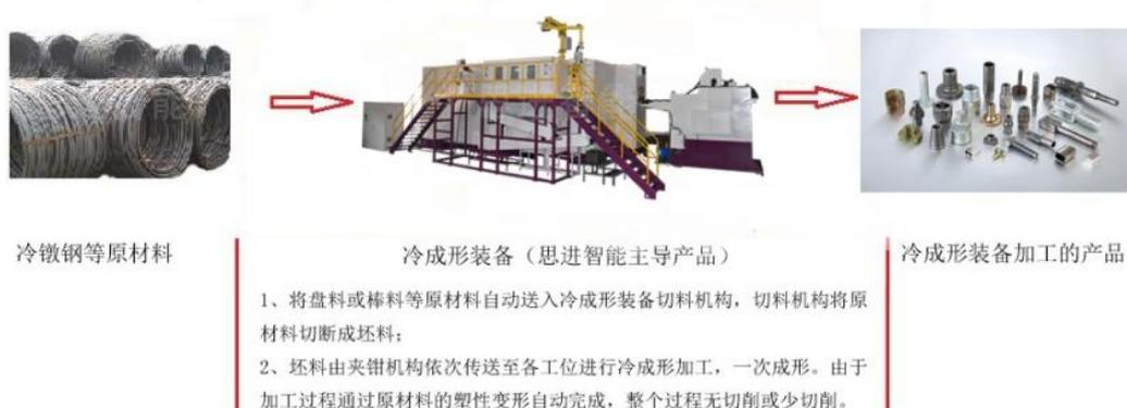
公司持续加大新产品研发力度。截至当前, 公司可以生产八工位以内的冷成形装备。冷成形装备的“工位”数指加工产品过程中的变形次数, “工位”数一般与冷成形装备的定模数一致。公司冷成形装备在加工产品过程中, 采用回转工作台或回转夹具等, 使工件先后在机床上占有不同的位置进行连续加工, 每一个位置上进行一次动模冲击定模的加工变形, 称作一个工位。如五工位冷成形装备就是将工件经过五次加工变形后, 生产出符合要求的产品, 某型号零件在其内部变形加工过程如下图所示:
