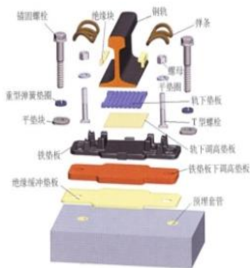
WJ-7型扣件组装零件图
