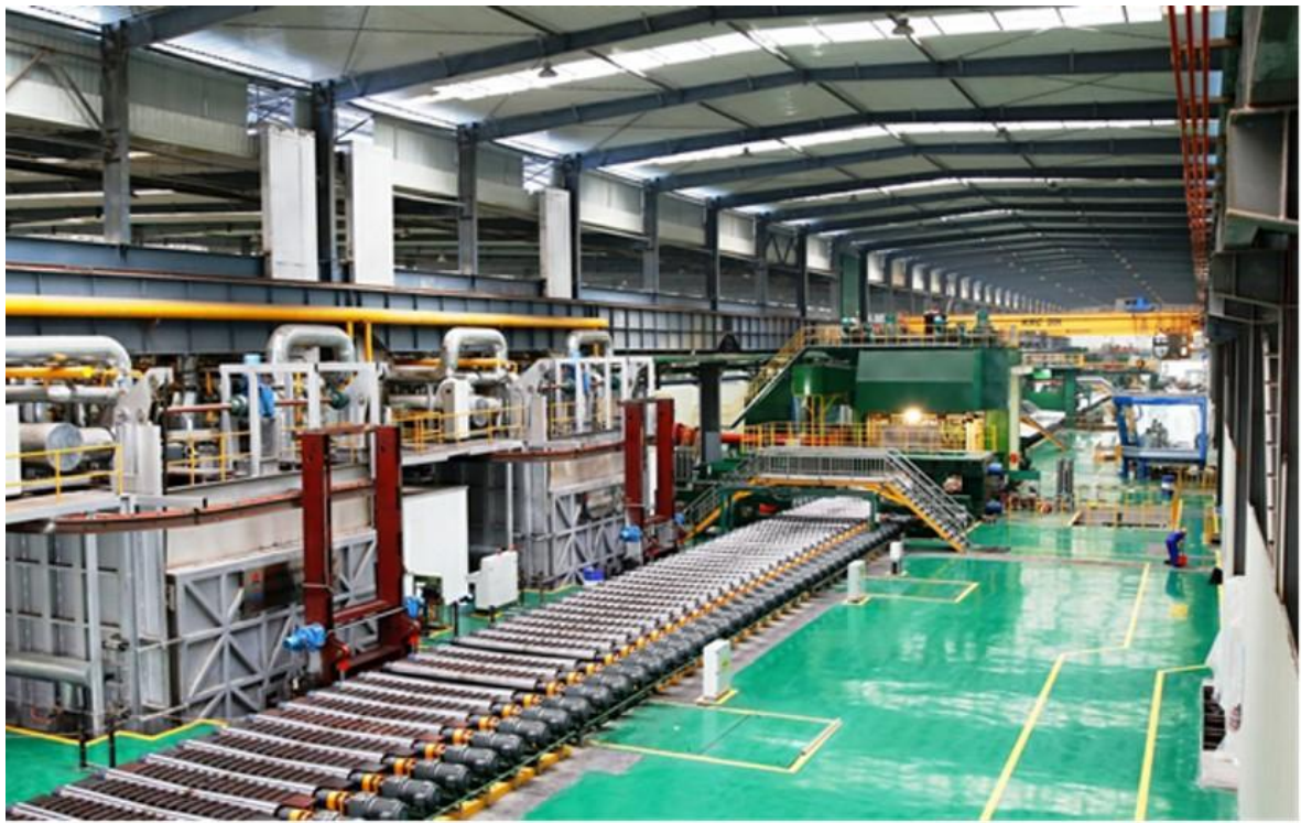
2800mm 宽幅高精度铝合金板带六辊冷轧装备研制及应用
