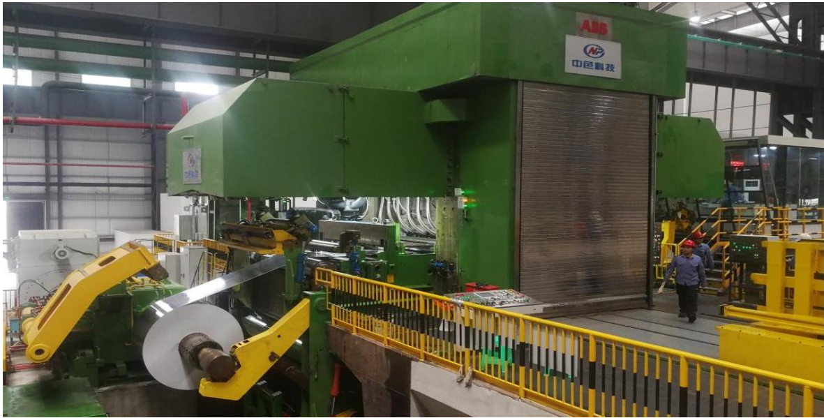
2800mm 宽幅高精度铝合金板带六辊冷轧装备研制及应用
