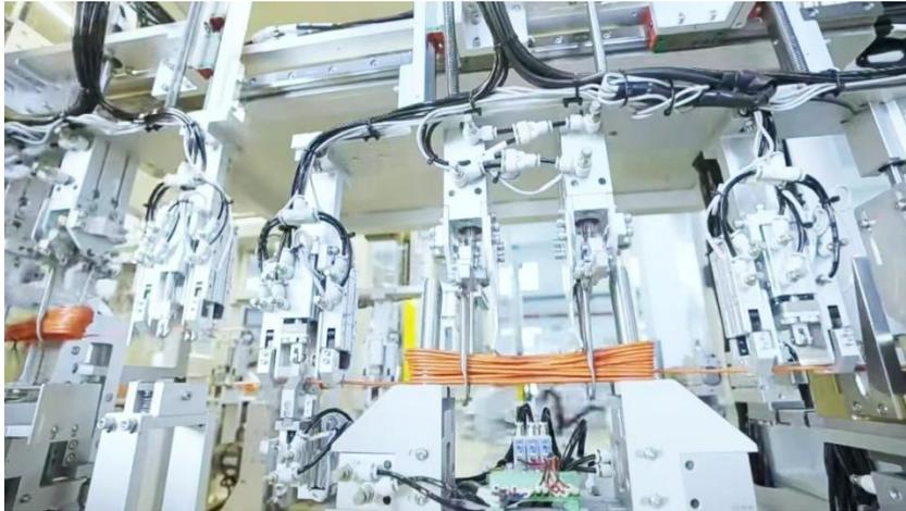
电子雷管生产线
