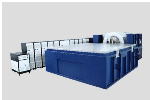
600kN 超大推力振动台
