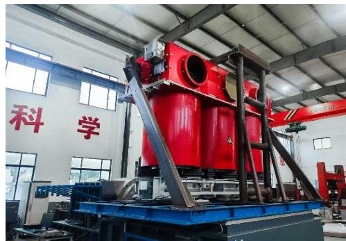
海上风电电机舱变压器振动冲击试验
