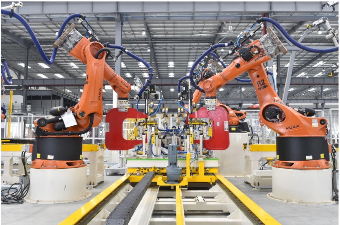
图：FDS、SPR 连接工艺应用于产线中
