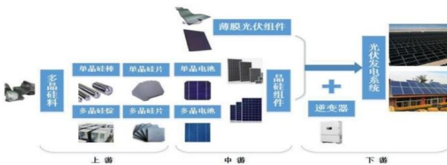
公司产品可用于硅料及硅片生产、制造环节。公司产品硅芯炉主要用于制备多晶硅料所需的多晶硅芯，单晶生长炉主要用于将多晶硅料制备成单晶硅棒。
