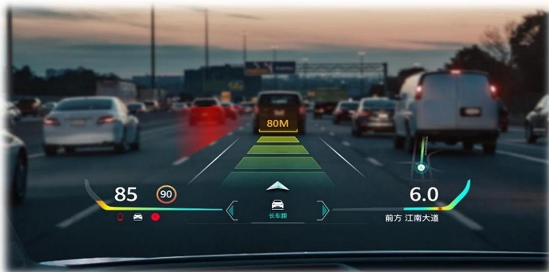
公司还提供对赋能 HUD 应用至关重要的 LCOS 产品。HUD 通过将信息直接投影至用户的视野内，通常是在透明及反光的表面上，为便利驾驶员操作及驾驶安全提供更强支持。在汽车 AR-HUD 的应用方案上，LCOS 作为反射式投影技术，与目前主要应用的 DLP 方案相比有着更好的透光率及更高的耐热性，能保证更好的性能从而也能更好的保护驾驶员的安全。随着 LCOS 技术的不断成熟，目前公司 LCOS 产品已在汽车 AR-HUD 方案中实现量产
