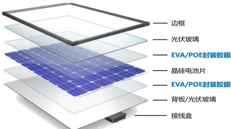
太阳能封装胶膜的成本主要由原材料构成，约占整体成本的 90% 左右，其中主要是 EVA 粒子、POE 粒子以及助剂（交联剂、稠剂、抗氧化剂、光稳定剂等）。其中助剂的配方及使用将直接影响太阳能封装胶膜的性能和质量，生产厂家需要具有长时间的经验积累和持续改进优化的能力。
