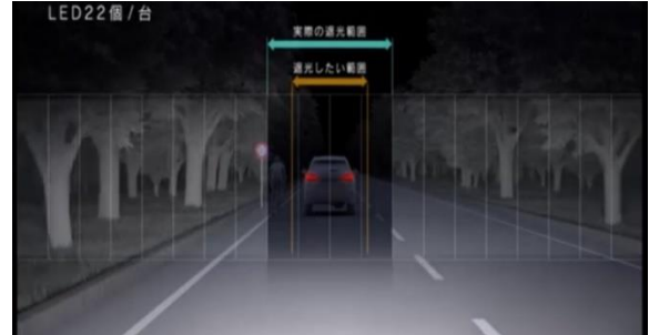
极速旋镜式远光自适应系统（BladeScan）
