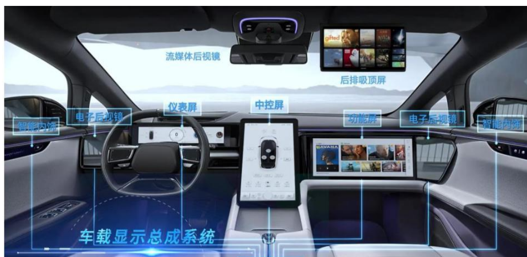
图：汽车智能座舱中车载屏幕分布图
