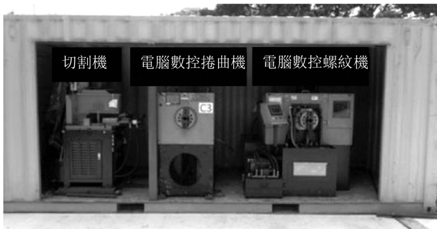
位於車間的三種機械鋼筋並接機
