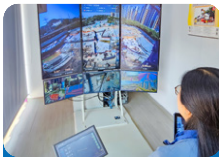
下高埔村項目採用智能天秤提高施工安全
