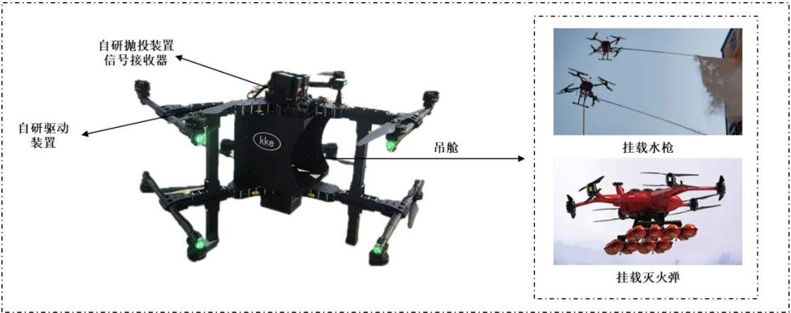
标的公司自研双层十二翼面民用灭火无人机
