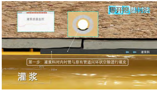
⑤管道内壁破损修复
