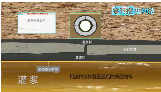
⑨垫衬法修复管道后纵向截面图
