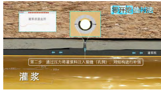
⑥对原有管道结构补强
