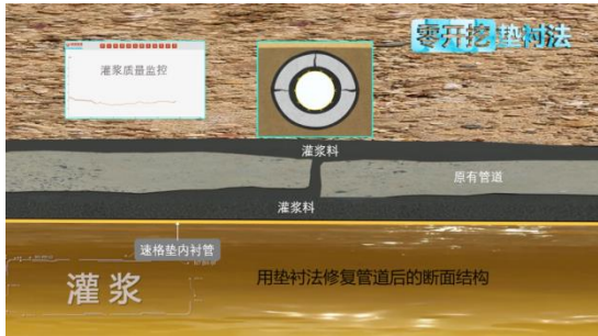
⑨垫衬法修复管道后纵向截面图
