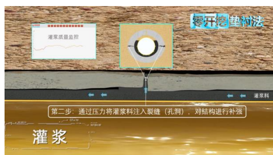
⑥对原有管道结构补强
