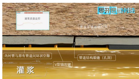
④原有管道缺陷
