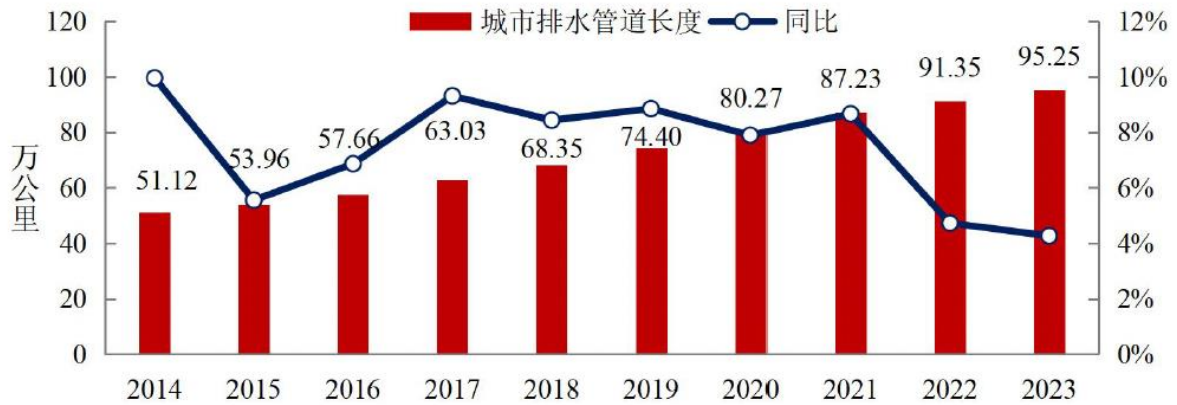
2014—2023年全国城市排水管道长度及同比变化
