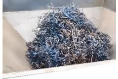
生铁、废钢等金属原材料 |
