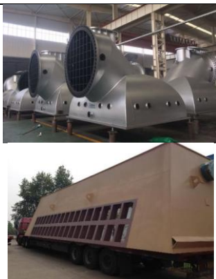
凝汽器部件（水室、喉部）
