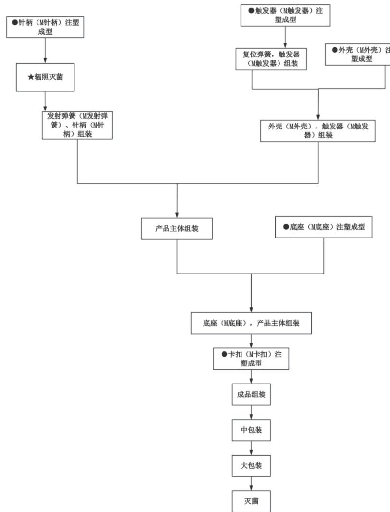
根据不同产品的生产工艺流程，普通采血针的部件较少，公司采取上针、压针、真空吸针、针转移并将针管与注塑件一体成型的生产工艺，之后检验、包装、灭菌后完工入库；而安全采血针部件较多，涉及不同部件的注塑、组装、检验等环节，生产工艺复杂，需要将针柄注塑成型后与采血针、发射弹簧进行组装，再将其与另外注塑成型的部件如触发器、外壳、底座、卡扣、发射弹簧等进行组装、包装、灭菌后方可入库，生产工序较多。
