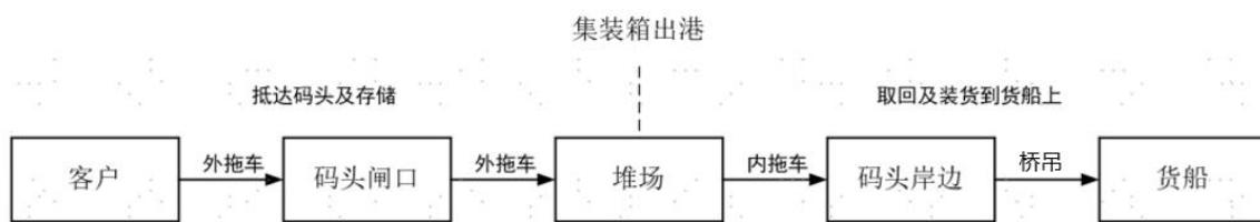
货主安排外拖车将集装箱通过码头闸口运至码头堆场，由码头工作人员操作龙门吊将集装箱放至堆存指定场位临时储存；装船时，由工作人员操作龙门吊取出集装箱并放置于内拖车上，并由内拖车将集装箱运至码头岸边，工作人员操作桥吊将集装箱从内拖车上吊起，并装至货船上，最终由货轮运至指定目的港。
