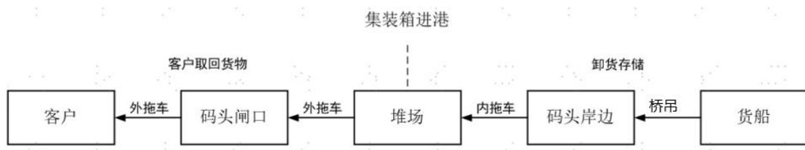
集装箱货船到港后，码头工作人员操作桥吊将集装箱从货船上卸下并放置于内拖车上，由内拖车运送至堆场，再由工作人员操作龙门吊将集装箱放置于堆场指定场位临时储存；货主提箱时，由工作人员操作龙门吊取回集装箱并放置于外拖车上，并由外拖车将集装箱运出码头闸口，最终运送至货主指定地点。
