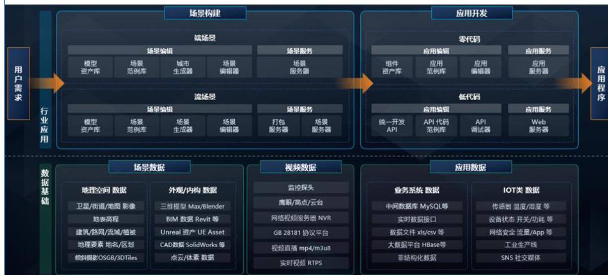
“图观”引擎具备自研的“端流双渲染”模式，同时提供端渲染和流渲染两种场景构建模式。可以根据用户的硬件实际情况，最大限度利用用户的硬件资源。端渲染模式，可以充分利用客户端算力，用较低的服务器端配置，获得较高的并发访问能力，最大限度利用用户的硬件资源。流渲染模式，可以构建强大的服务器端算力，适用于大规模场景、高性能实时渲染，在较低配置的客户端下，也可获得超凡渲染效果。
