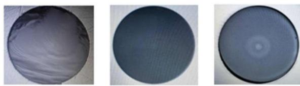
通过光纤切割刀裁切的光纤端面会呈现凹凸不平的状态，存在明显的台阶或斜面，部分端面甚至会存在毛刺或裂纹，会导致光纤连接不稳定；工厂研磨光纤端面光滑平整，无划痕、气泡和杂质等缺陷，端面呈现轻微的球面形状，光纤纤芯位于弯曲的最高点；由光纤熔端机现场熔端得到的光纤端面与工厂研磨光纤端面较为相似，光纤端面光滑，可以满足连接后优异的性能和较久的寿命。
