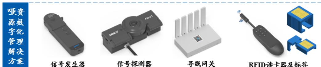
哑资源数字化管理解决方案是通过在光信号上游端口附近对光纤进行特定频率的弯曲使光纤产生特定频率的较小的光功率变化，并在信号下游端口附近通过夹持探测器探测该特定频率的光功率的变化，从而确定上游端口和下游端口的对应关系，可以通过多个探测器与信号发生器的组合实现纤芯资源的高效率普查。此外，通过 RFID 读卡器和标签系统，实现光纤连接器及其对应的光纤适配器标签对在现场的物理关联和在资源系统中的信息关联的相互对应，实现标签之间相互之间的可校验性，并对哑资源的数字化管理。
