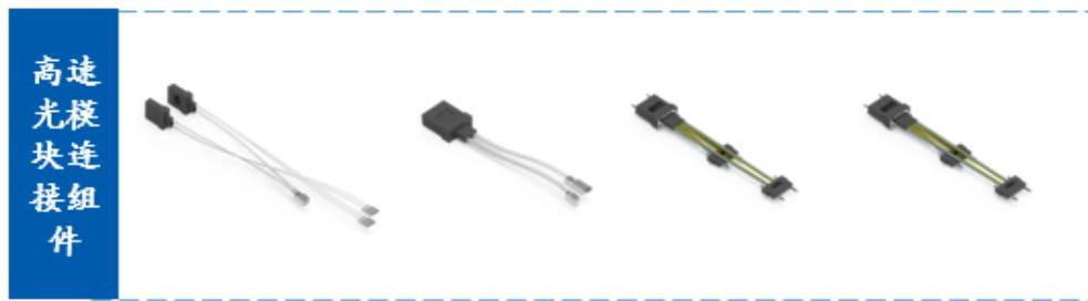
高速光模块连接组件中的 MT 端用于连接外部光接口，FA 端用于耦合光模块内部的探测器和激光器，实现光信号传输，是头部光模块厂家应对高速率传输需求的主流设计方案。FA 光纤阵列是采用一定厚度的玻璃盖板将光纤可靠固定在基板上按照一定 core pitch 亚微米级精度排布的 V 型槽内的原理，为光模块厂家提供了充分的产品尺寸定制选择。FA 光纤阵列对材料和制造工艺的要求较高，为了满足高速率光模块的严苛环境测试，首先需要对基板等物料进行特殊处理以保证胶水和材料的粘接性能；然后借助自行设计制作的精密安装平台，将清洗好的光纤精准安装到 FA 基板 V 型槽中，再通过一系列的粘接、固化、研磨、定长加 MT、测试等工序，完成产品制作交付。除此之外，发行人在产品下游工序上继续深挖，配合客户完成部分产品贴 Lens 和隔离器的工艺方案。
