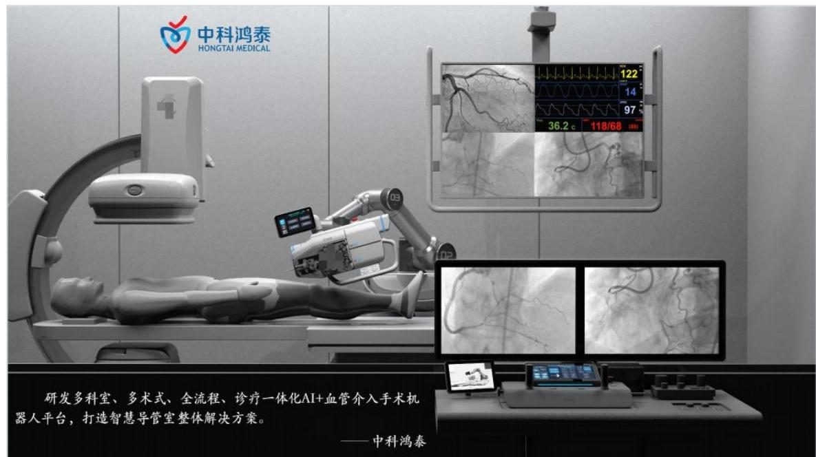
中科鸿泰首款产品“血管介入手术机器人”目前已生产出产品样机，该产品实现了同时操控两根导丝及球囊/支架、主控端与递送端实时通信与控制、多器械切换与协同操控、以及每根导丝的推送和旋转操控的功能，其核心技术均为自主研发。该产品搭配血管造影机（DSA），为医生提供远距离有线（或无线）控制血管介入机器的遥控手术方案。
