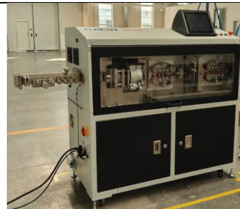
HBQ-421 全自动屏蔽线下线机 (长宽高: 1.46m*0.7m*1.5m)
