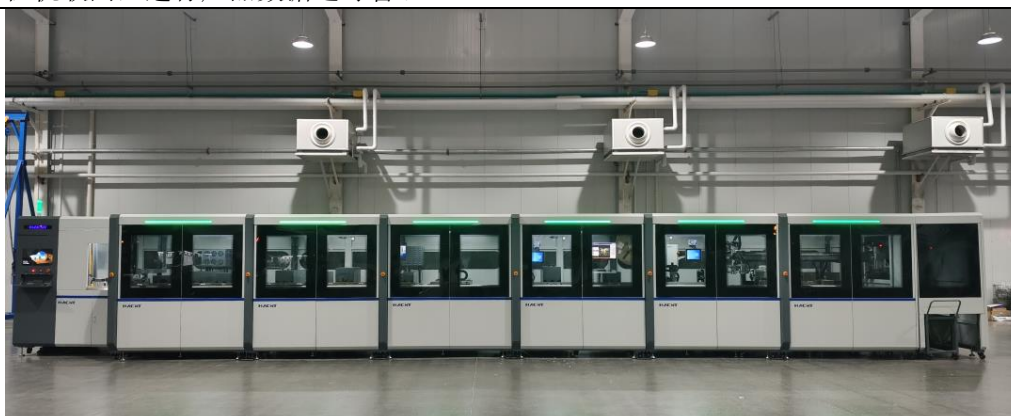
HBQ-961 新能源线束全自动加工生产线 (长宽高: 25m*2.4m*2.2m)
