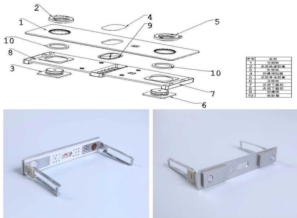
方形盖板主要由光铝板与密封圈、极柱、防爆阀、下塑胶等部分组成，各部件的工作原理如下：
