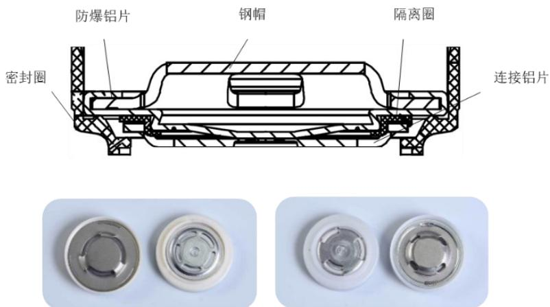
圆形盖帽由密封圈、防爆铝片、钢帽、隔离圈和连接铝片等部分组成，各部件的工作原理如下：
