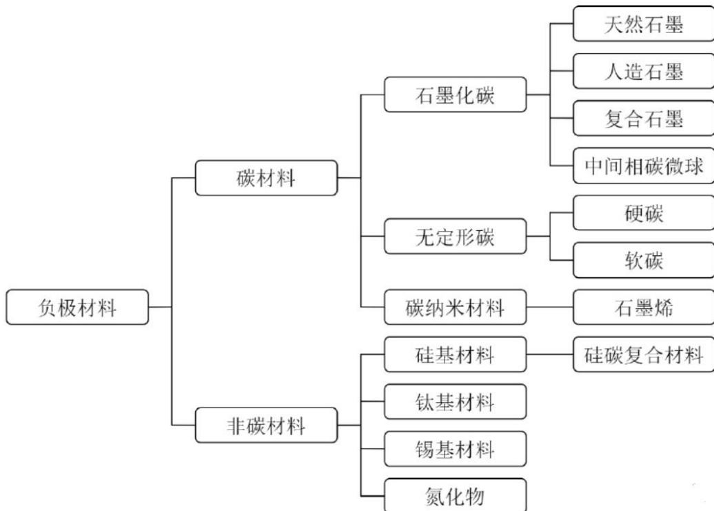
不同类型的负极材料性能不同，理想的负极材料应具备以下特质：（1）具备较低的氧化还原电位，以确保能量得以高效转换；（2）拥有较高的储锂容量，从而提供更大的能量密度；（3）展现良好的电子和离子传导性能，保证电池快速充放电；（4）具有优异的结构稳定性，以维持电池长期使用的循环稳定性。
