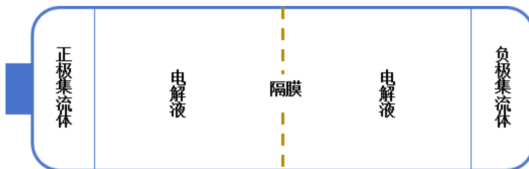
锂电池结构示意图
