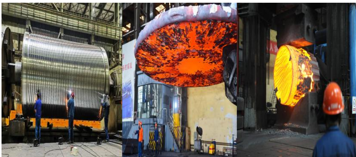
图示：等静压机超高压筒体、石化加氢管板锻件、大型支撑辊锻件
