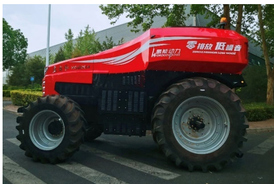
图注：国内首款集成应用大马力智能氢动力拖拉机 HQ2204
