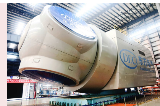
17兆瓦直驱型漂浮式海上风电机组
