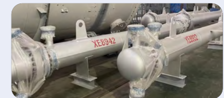
工业废水处理换热器
