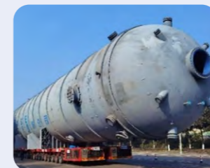
钛钢复合板醋酸回收塔
