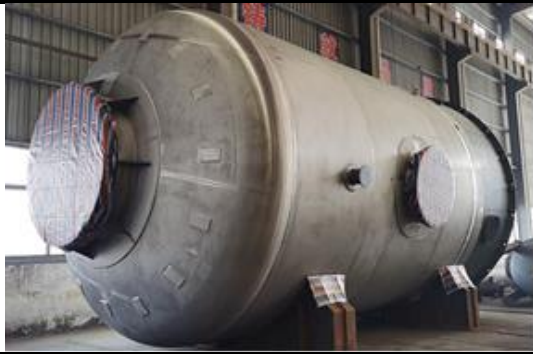
炼油低压空气气体分液罐
