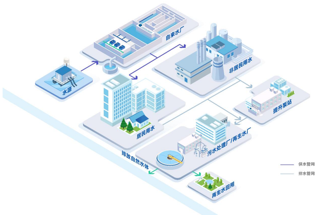
图 3：管网工艺流程图
