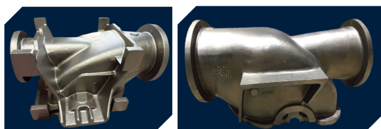
超級雙相鋼中開泵生產單重突破至2.8噸
