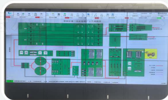
渭南清荷自控系统
