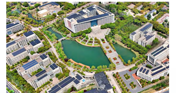
马鞍山公司安徽工业大学校园光伏发电站每年可供应绿电约700万千瓦时，年减碳量达4950吨，减排二氧化硫950千克
