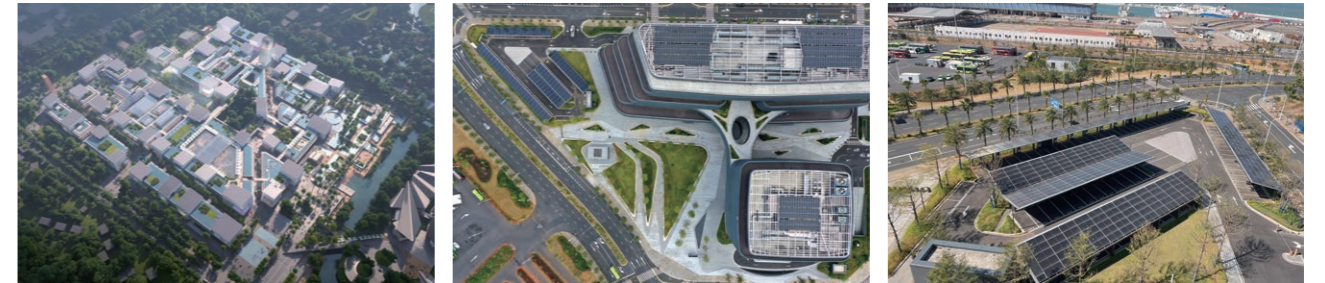
△ 海口國際免稅城地塊一中旅大廈建設的屋面和車棚光伏發電裝置
