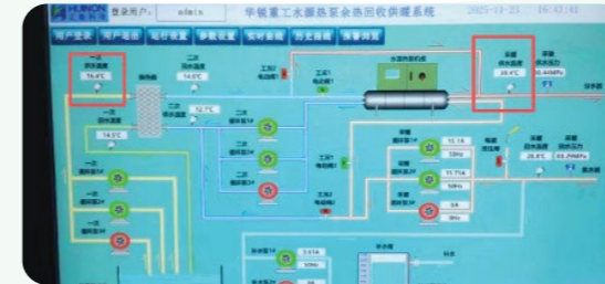
熔炼冷却水余热热泵采暖系统
