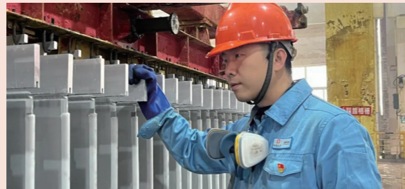
检查新阴极板入咬槽浸泡情况
