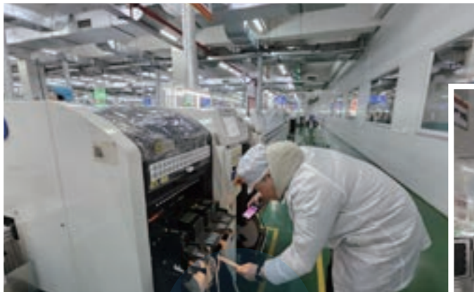
利用MES移动端进行数字化防错上料，确保物料精准投用
