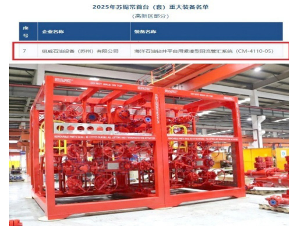
CM-4110-05 海洋石油钻井平台用紧凑型阻流管汇系统
