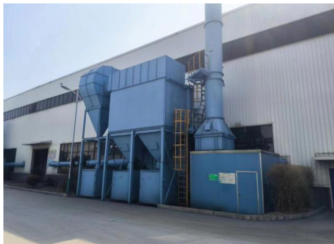
旋风-活性炭组合除尘系统用于工业生产中空气污染防治，高效去除气体中的颗粒物、有机气体及恶臭物质，满足严格环保排放标准。
