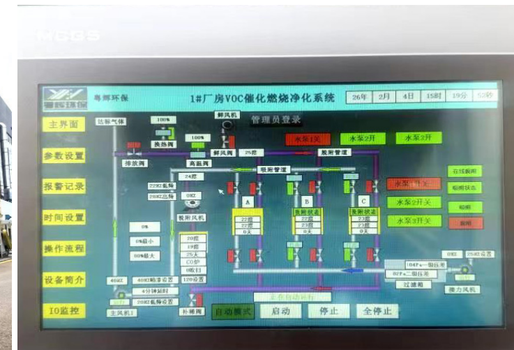
“气旋混动喷淋塔+干式过滤+活性炭吸附+浓缩催化燃烧技术 (RCO) 组合工艺”，通过催化燃烧将饱和的活性炭脱附再生，确保废气处理效率维持稳定，减少危废废活性炭产生。
