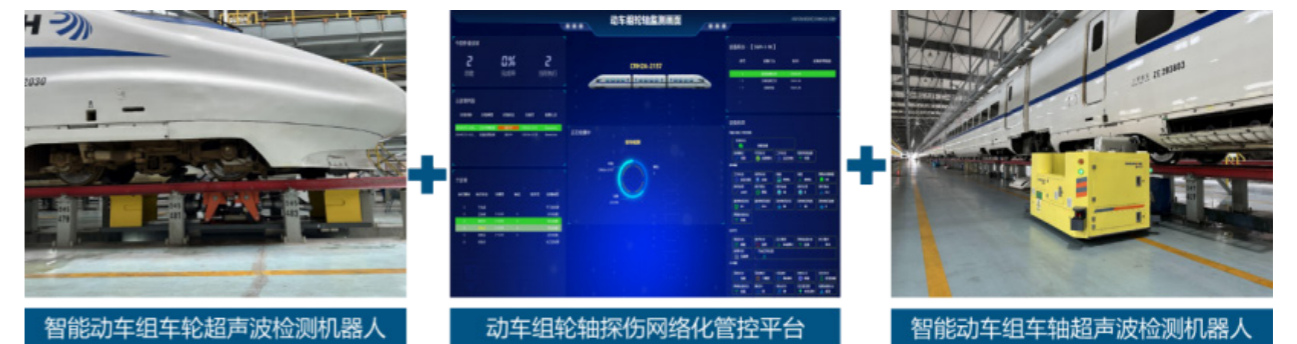
新联铁 - 动车组轮轴无人化超声检测系统
