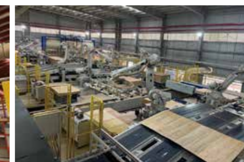
胶合板产线—机器人自动组坯
