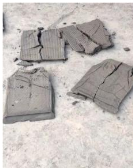
超压缩叠袋压滤机试验效果水分 17%
