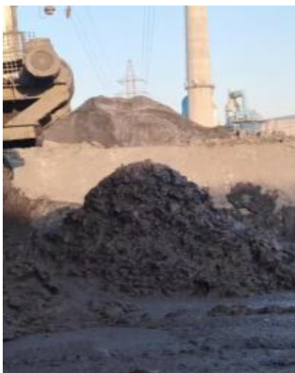
原有压滤不成饼，压滤后水分超 30%
