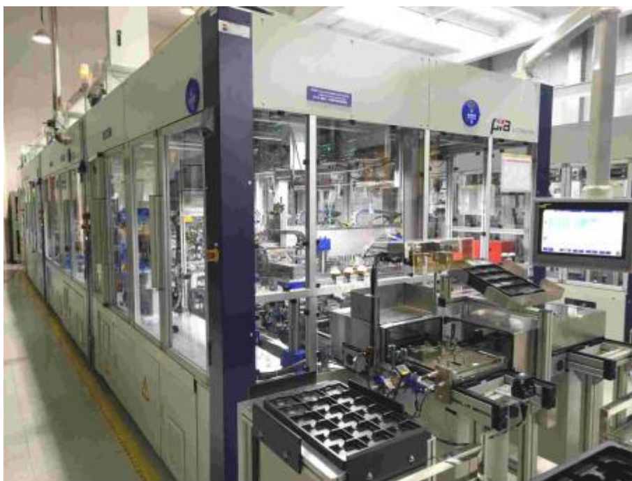
图：4D 毫米波雷达的装配与检测线
