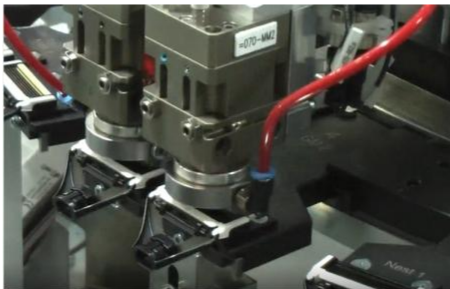
图：湿式剃须刀五层刀头装配线系统
